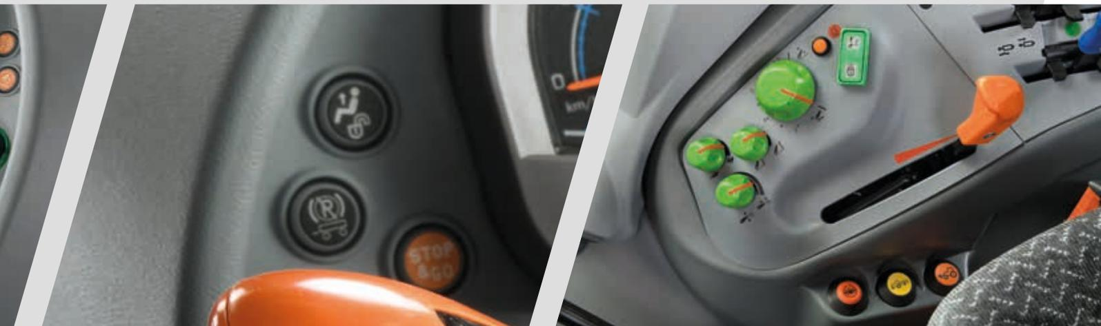
> La función Stop&Go permite al conductor detener y retener el tractor sin utilizar el pedal del embrague.
